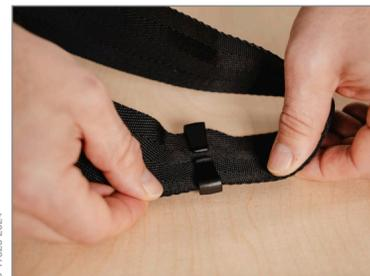
Montieren Sie auch die Gurtklammer wieder und überprüfen Sie, dass die beiden Steckschnallen ohne verdrehten Gurt zusammengesteckt werden können.
