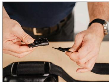
Montieren Sie den Stecker wieder, indem Sie den Gurt zuerst von unten durch die vordere Öffnung am Stecker und dann zurück, von oben durch die hintere Öffnung fädeln.
