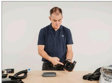
Kontrollieren Sie alle Komponenten, insbesondere den Dichtring, auf Beschädigungen und nutzen Sie das Gerät nur in einwandfreiem Zustand.
