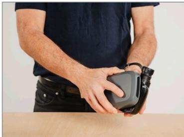
Setzen Sie den Partikelfilter in einem 30° Winkel auf den Bajonettanschluss am Gerät und drehen Sie ihn im Uhrzeigersinn, bis er hörbar einrastet.
