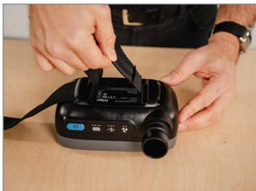
Führen Sie das freie Gurtende auf der Rückseite des Gerätes durch die beiden Schlaufen.
