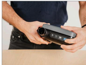
Prüfen Sie den Ladezustand des Akkus im ausgeschalteten Gerätezustand, indem Sie die blaue Taste auf dem Bedienfeld kurz drücken. Laden Sie den Akku bei Bedarf vor dem Einsatz.
